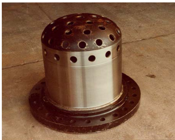
Figura 23.4 - Particolare di un espansore per scarico vapore.
